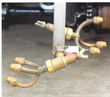
Door de drie schuin omhoog staande nozzles dringt de spuitvloeistof beter door in het gewas.
