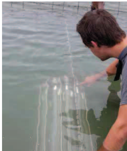
Voor een betrouwbare werking van de UV-lampen moet het water helder zijn.
