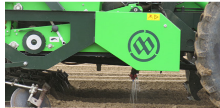
Figuur 10 – Precisiebemesting in de rij om plaatsingsruimte te besparen.
